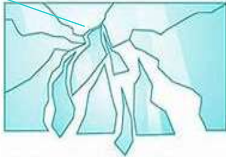
Rotura de Vidrio Normal
